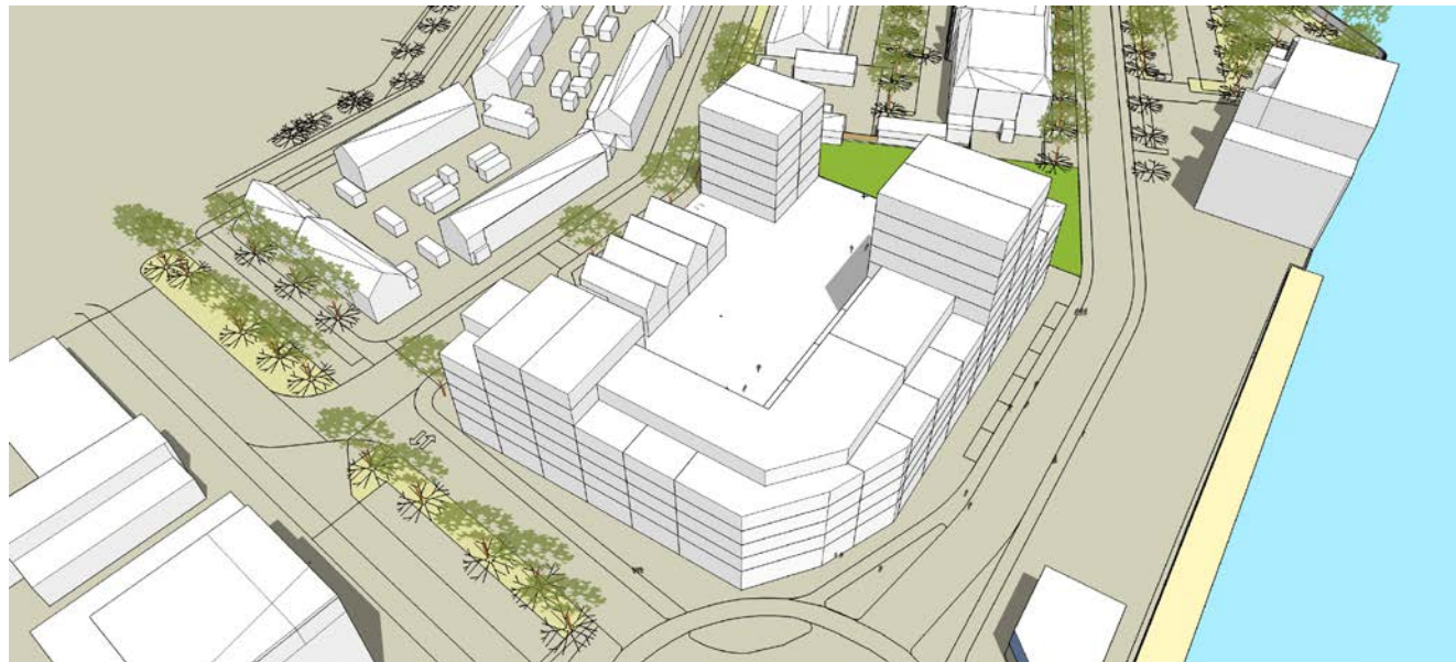
MODEL 2 het samengestelde bouwblok met halfverdiepte garage
